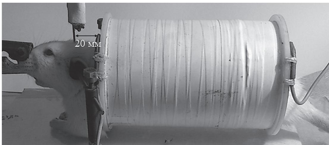
**Рис. 2.** Экспериментальная установка (соленоид) для облучения тела крысы сверхнизкочастотным магнитным полем. Магнитная индукция в центре соленоида составляла 2,34 Гаусса. Стрелкой показано расстояние от датчика для регистрации мозгового кровотока до края соленоида (20 мм). Магнитная индукция около датчика составляла 0,73 Гаусса. Голова животного жёстко зафиксирована в стереотаксической рамке с помощью носового и ушных зажимов.
